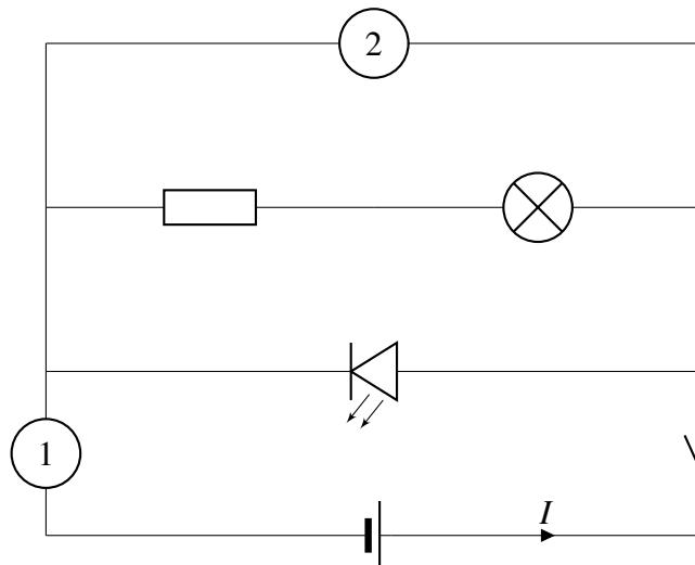
On ferme l'interrupteur. La DEL fonctionne correctement alors que l'ampoule est allumée faiblement. L'intensité du courant qui circule dans la DEL est notée  $I_D$  et vaut  $I_D = 0,1$  A et celle qui circule dans l'ampoule est notée  $I_L$  et vaut  $I_L = 10$  mA.
