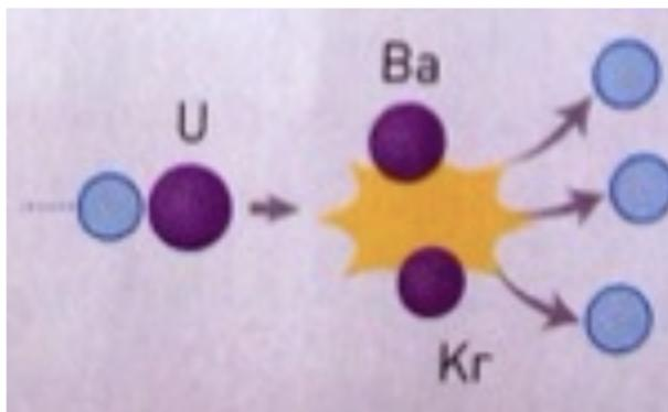
La formation de neutrons provoque d'autres transformations : la réaction est dite en chaîne. L'énergie libérée permet de chauffer l'eau qui se transforme en vapeur.
